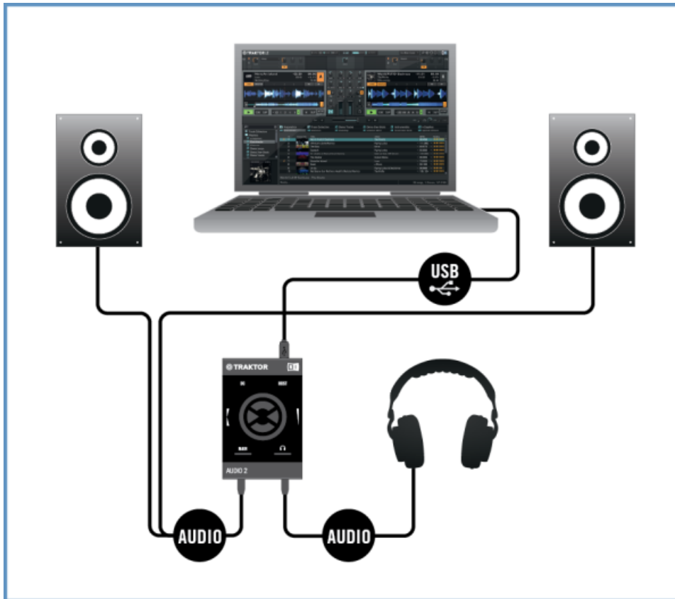
Vue d'ensemble de la configuration de la TA2 avec un ordinateur en mode Internal Mixer.
