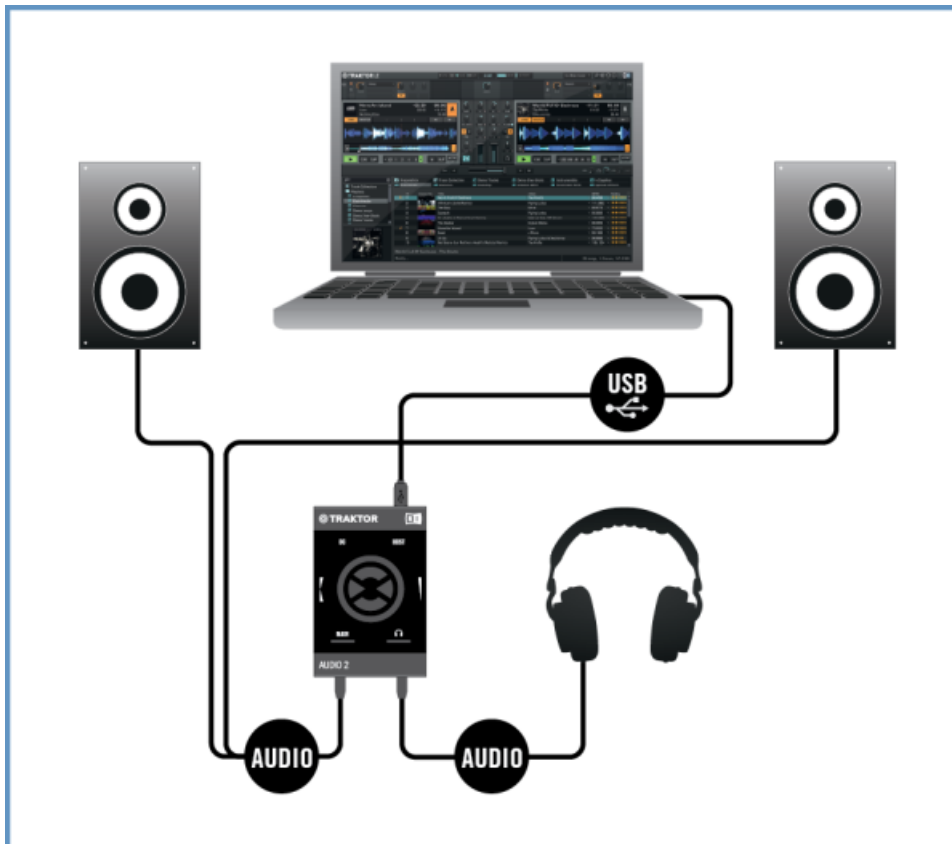
Montaje del TA2 en el modo de mezcla interno con un ordenador.
